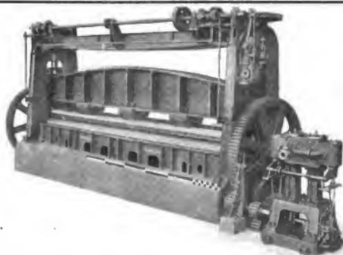
**Blechbiegemaschine** für Bleche bis 10 m Breite, 40 mm Stärke in kaltem Zustande mit 3 massiven Walzen von geschmiedetem Stahl Gewicht ca. 16 000 kg
